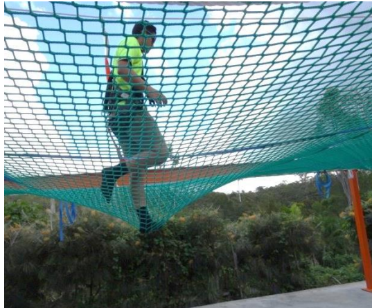
Şekil 13: Yük sonucu esneme
