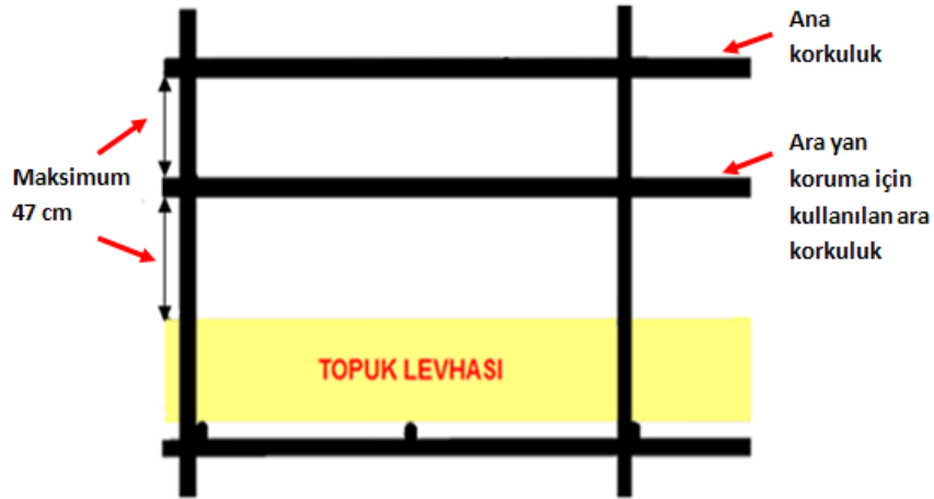
Şekil 16: Topuk levhası ve ara korkuluk
