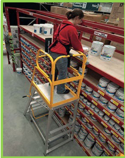
Şekil 5.2. Platformlu merdivende çalışma [10]
