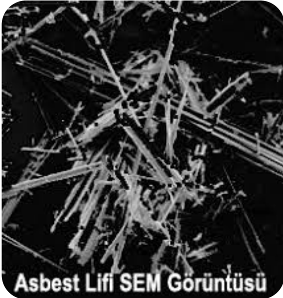
Asbest Lifi SEM Görüntüsü
